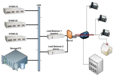
Cette topologie fournit un service, disponible, hautement augmente capacité d'appels et d'utilisateurs, simultanés (équilibre de charge). Des iX2500 supplémentaires peuvent être ajoutés au réseau si la capacité l'exige.
